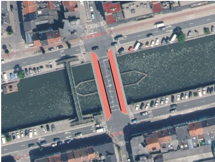
Figuur 8-1 - concept oplossingsvoorstel 1a: verbreden Wondelgemstraatbrug
