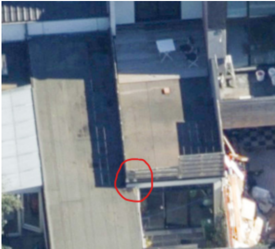
Figuur: Luchtfoto die het niveauverschil duidelijk maakt tussen de kroonlijst van plat dak op perceel nr. 20 en het plat dak op het perceel tussen nr. 18 en nr. 20.
